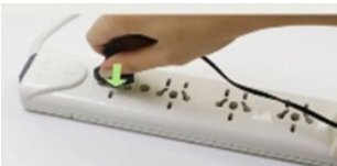
شكل (٥) توصيل بمنفذ كهربائي
