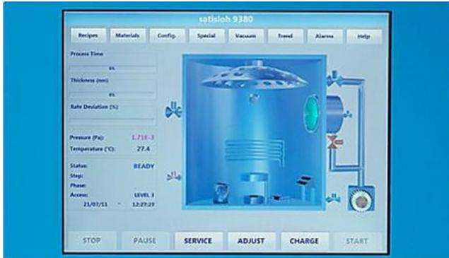
صورة (6) يوضح ضبط النسب من الغازات المستخدمة ودرجه حرارة التفاعل عن طريق شاشه تعمل باللمس.
