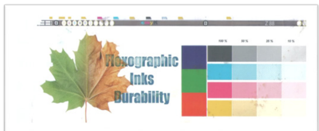
شكل (3) يوضح فيلم البولي بروبيلين المطبوع بحبر فلكسوجراف ذات قاعدة مذبذبات Solvent مغطى بالورنيش فوقى
