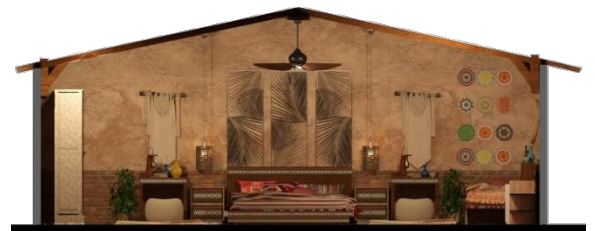
شكل (34) - قطاع رأسي طولي Longitudinal Section لتوضيح التصميم الداخلي داخل كابينة المجموعات - عمل الباحثة - موضحة السقف الخشبي الجمالوني للكابينة من خشب wpc المقاوم للحرارة والرطوبة
