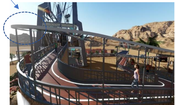
شكل (27) - الممشى المؤدى إلى داخل المرصد البيئي - استخدام الخلايا الكهروضوئية في تصميم سقفية الممر المتدرج المؤدى إلى داخل المرصد - استخدامها لتوليد طاقة كهربائية لإنارة الممشى وداخل المرصد ليلاً
