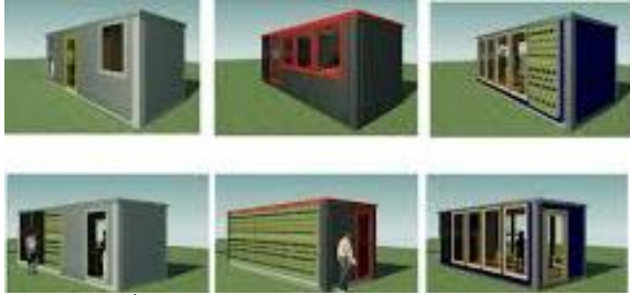
شكل رقم (22) تهيئة الحاوية المعدنية لتكون منشأ معماري
