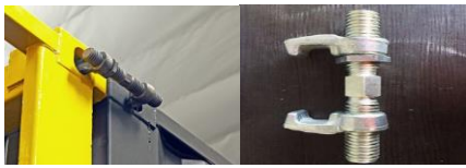
شكل رقم (26) يوضح تجميع الحاويات بشكل أفقي
