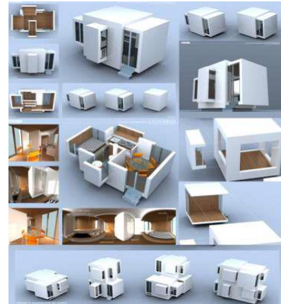
شكل رقم (24) تراكب الحاويات المعدنية بالدمج والحذف مشكلة فراغاً معمارياً
