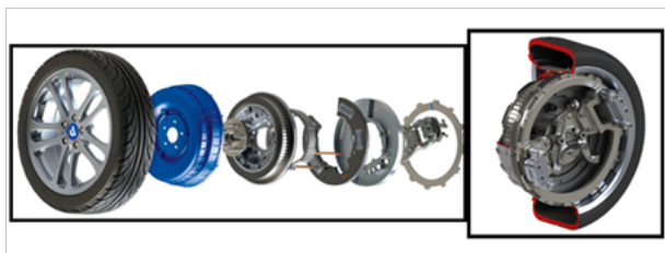
شكل رقم (١٠) صورة توضح أحدث المحركات المنتجة من خلال شركة Protean Electric الأمريكية التي تعمل بمبدأ الطاقة الحرة Source: https://spectrum.ieee.org/protean-electrics-in-wheel-motors- (could-make-evs-more-efficient)
