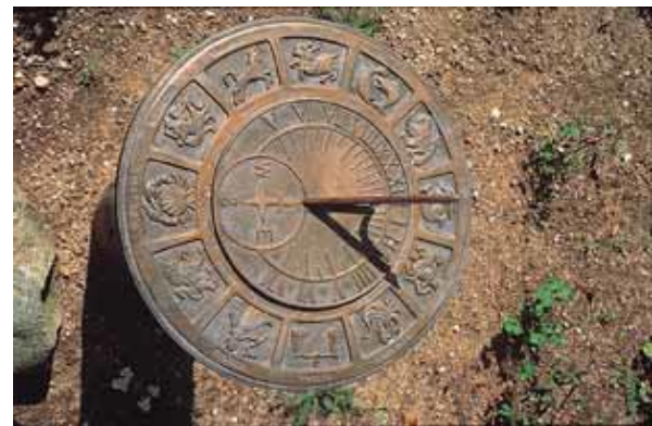
الشكل رقم (٨) يوضح صورة للمزولة الشمسية والتي تم نحتها على قطعة معدنية موضحة، والتي توضح الزمن عن طريق قياس زوايا الظل التى تنتج عن الشمس. ١٠
