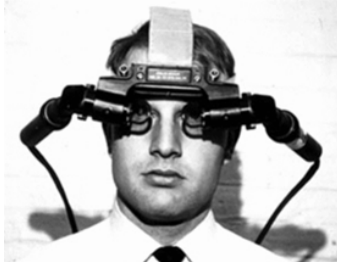
الشكل (٣) إيفان ساذرلاند Evan Sutherland صمم جهاز عرض ثلاثي الأبعاد مثبت على الرأس https://www.timetoat.com/timelines/realidad-aumentada .
