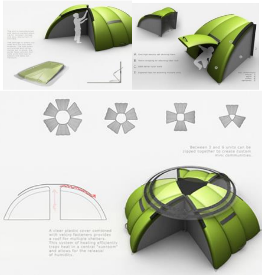
صورة (٢) وحدة سكن مؤقتة تتسع للوحدة الواحدة الى فردين فقط و كيفية تجميعها بعضها البعض لتتسع أكثر من ١٢ فرد ١٢
