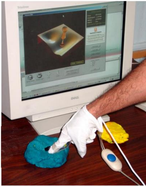
شكل (١٦) اليد الموجهة Hand Navigator أحدث أدوات تقنية الفري فورم للتشكيل بالطينة الرقمية.
