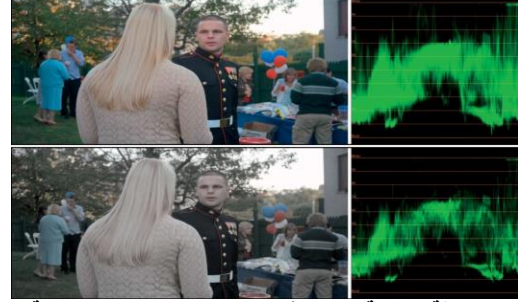
شكل (١٤): اللقطة العلوية توضح قياس لقيم التشبع اللوني العالية للقطعة سينمائية، أما اللقطة السفلية فهي تعبر عن قياس لقيم التشبع المنخفضة لنفس اللقطة، وذلك في صورة حزم موجية يتم رصدها رقمياً.
