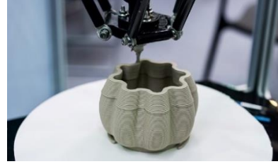
صورة (١٢) نموذج خزفي من خلال التصنيع بالإضافة عن طريق ماكينة الطباعة ثلاثية الأبعاد
