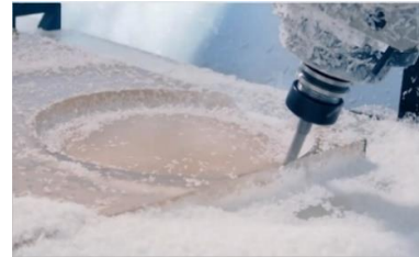
صورة (١٣) ماكينة CNC Router للحفر على الخشب
