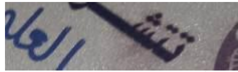
شكل رقم ١٣ يوضح عيوب الطباعة نتيجة الرطوبة (من تجارب الباحثين)
