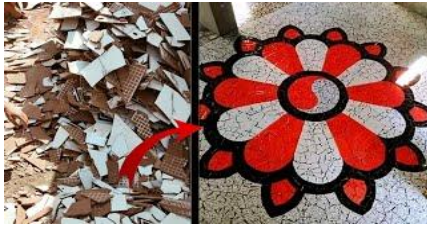
صورة رقم (١) توضح إعادة التدوير الميكانيكي عن طريق كسر السيراميك واستخدامه في أرضيات تصميم أرضيات مبتكرة. https://www.youtube.com/%87
