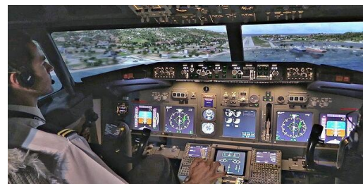
صورة (٢) : توضح الواقع الافتراضي شبه الغامر حيث ان الأدوات امام الطيار حقيقية بينما النوافذ تعرض محتوى افتراضي غير موجود (CyberPulse (2023)
