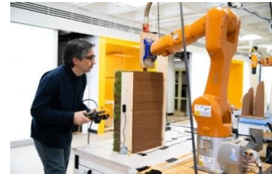
شكل رقم (٣٦) صورة توضح روبوت صناعى بامتداد من ٣ إلى ٤ أقدام يمكنه وضع المواد المخصصة وفقاً للأهداف المرغوبة من المصمم
