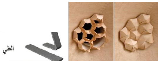
شكل رقم (٢١) يوضح تغير شكل الفتحات نتيجة الإستجابة للمحفز.
