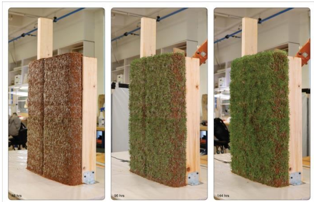
شكل رقم (٣٣) قطاع يوضح حائط داخلي مطبوع بتقنية الطباعة رباعية الأبعاد باستخدام تربة مزروعة بالبذور ينمو الزرع خلال عدد من الساعات .
