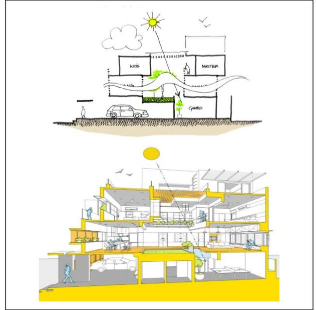
الشكل رقم (٧) يبين التدفق الحر للهواء والإضاءة الطبيعية عبر فتحات السقف وصولاً للحديقة (المرجع السابق)
