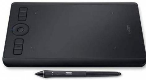
شكل (١٤) لوح الرسم الرقمي متصل بالحاسب ويتم الرسم عليه وترجمه الرسم على البرنامج الرقمي
