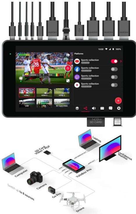
شكل رقم (١٦) جهاز Yolobox pro جهاز لوحي يعمل باللمس يوفر إمكانية المونتاج الفوري لعدد من المدخلات والبث الفوري علي مواقع البث الحي علي شبكة الانترنت. (yololiv.com,2024)
