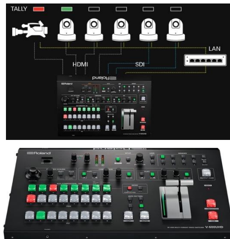
شكل (١٥) جهاز Roland V-600UHD للمونتاج الفوري لمصادر الصوت والصورة الحية. (proav.roland.com,2024)
