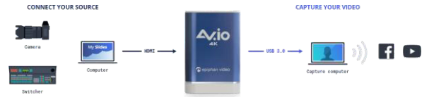
شكل (٧) كارت التقاط الصوت والصورة Epiphan Avio 4K كوسيط بين مصادر تسجيل الصوت والصورة المختلفة وجهاز الكمبيوتر. (epiphan.com,2024)
