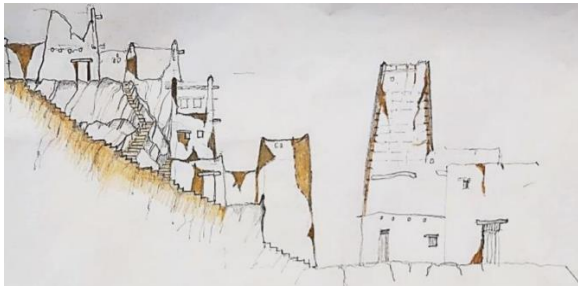
شكل (٤) : قطاع عرضي بقرية شالي الأثرية يوضح البناء بمادة الكرشيف والإرتكاز على صخور الهضبة للقرية مباشرة. (EQI-2021) تركيب الأسقف
