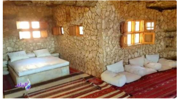
صورة (٣٩) توضح الخامات المستدامة في الفراغ الداخلي بغرف فندق أدير اميلال (https://www.albawabhnews.com/3294003) توضح الصور أبواب ونوافذ الفندق التي صنعت من خشب أشجار النخيل ، كما أنه خالي تماماً من الكهرباء ويتم إضاءة المكان بالشموع ليلاً وضوء القمر . واستخدام السجاد المصنوع يدوياً من خامات طبيعية.
