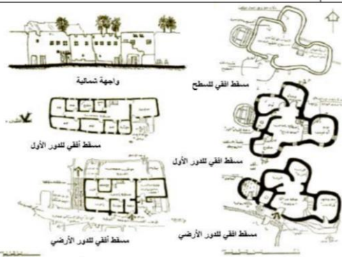
شكل (٥) يوضح بعض نماذج للبيت السيوي التقليدي ويتضح استخدام نظام البناء الحوائط الحاملة (EQI-2021)
