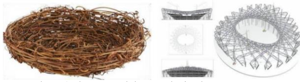
صورة (١٦) تصميم الهيكل الفولاذي لملاعب بكين الوطني علي هيئة "عش طائر"
