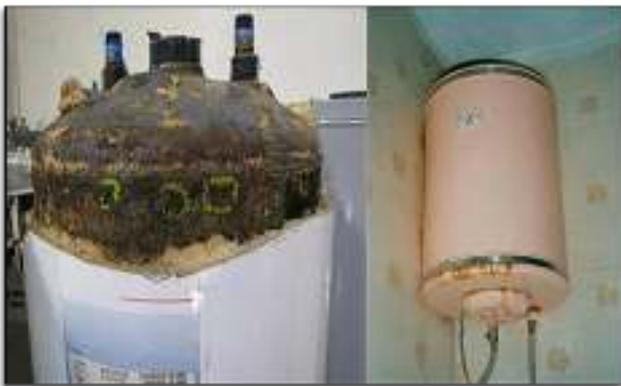
الشكل رقم 5- حالة تسريب مفاجئ للماء من جسم السخان و يظهر الشكل وجود ثقب في بدن الخزان بالقرب من خط اللحام القطري للخزان نتيجة عملية الصدا والتآكل
