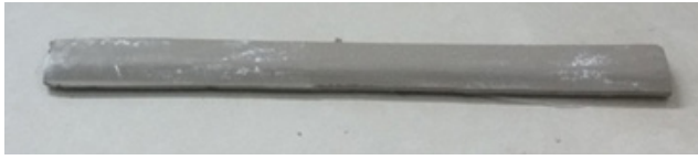
شكل (13) يوضح شكل المسطرة التي تستخدم في قياس الالتواء
