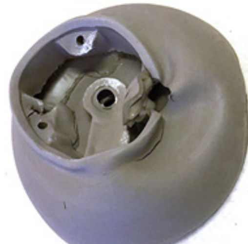
شكل (2) يوضح مشكلة التواء الصب
