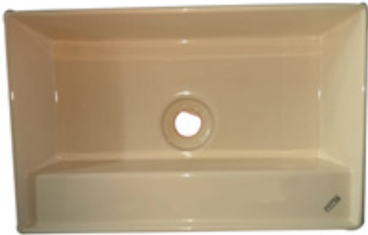
شكل ( 20 ) الحوض بعد صبه بخامة fire clay
