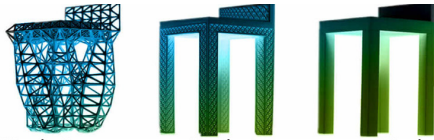
نموذج (1) التصميم التقليدي ذات القوائم المصممة وزنه : 10.3 كيلوجرام نموذج (2) التصميم الذكي ذات الشبكية المنتظمة وزنه : 4.1 كيلوجرام نموذج (3) التصميم التوليدي ذات الشبكية المفرغة الغير منتظمة وزنه : 2.9 كيلوجرام
